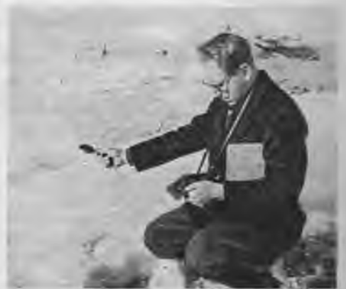
No sniega un ledu virsas atstaroto saules enerģiju izmērī ar fotometru.
